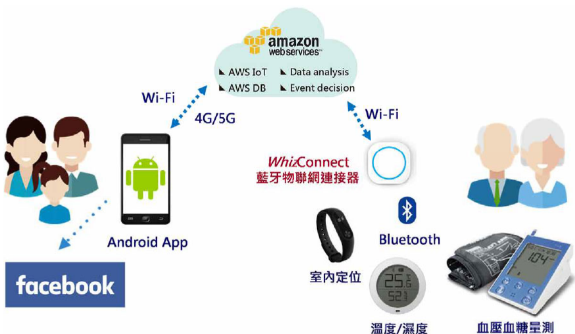
圖 1. 應用物聯網技術的創新遠距居家照護系統架構
